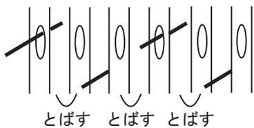
\* 縦糸はヘッドルの穴と隙間を1つずつとばして通します。
