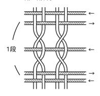
\*ヘドルをレストポジショ ンに置いて、縦糸を1本 ずつ指ですくい、となり の糸と交差させます。 交差させた縦糸の間に シャトルを通します。 端まで通したら、ヘドル を寄せて織ります。
